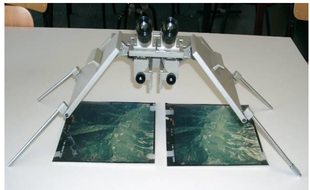
Lo stereoscopio a lenti e specchi e, qui sotto, le fotografie aeree stereoscopiche
