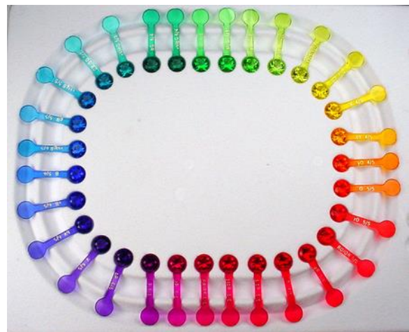
Colorimetro GIA per la determinazione del colore
