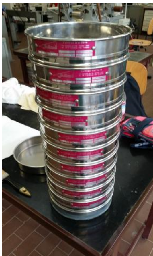
Figura b. Serie di setacci usata per il setacciamento di un campione di terreno.
