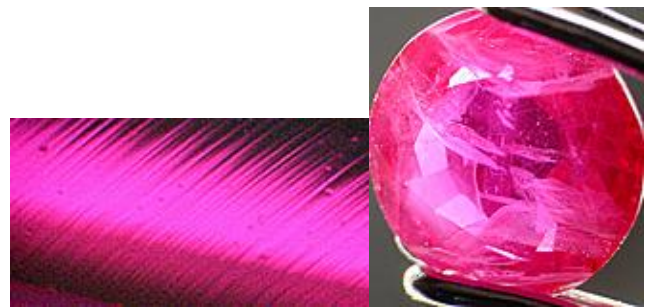
Inclusioni a strie curve in rubino sintetico; inclusioni a "impronta digitale" in rubini naturali
