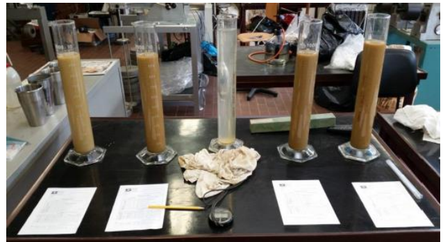
Figura c. Esempio di prova di densimetria su campioni di terreno.
