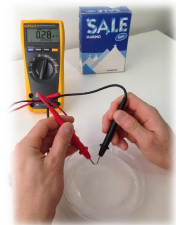
Figura 16: misura della resistività della soluzione acquosa satura in cloruro di sodio.
