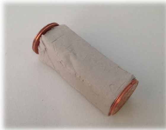
Figura 11: campione di DAS® con monete in rame applicate sulle superfici di misura.
