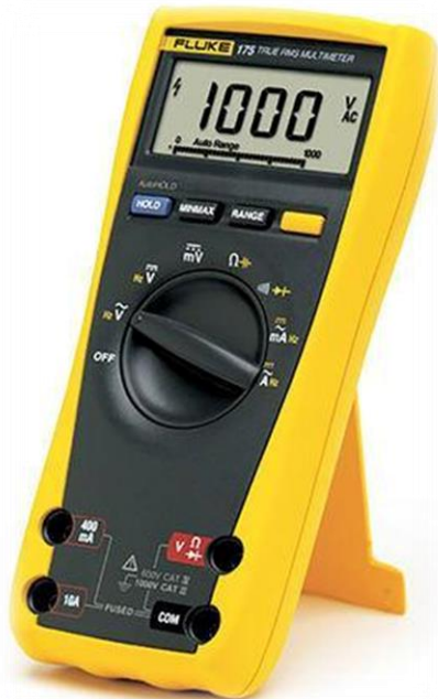
Figura 5: multimetro digitale a True RMS Fluke 175.
