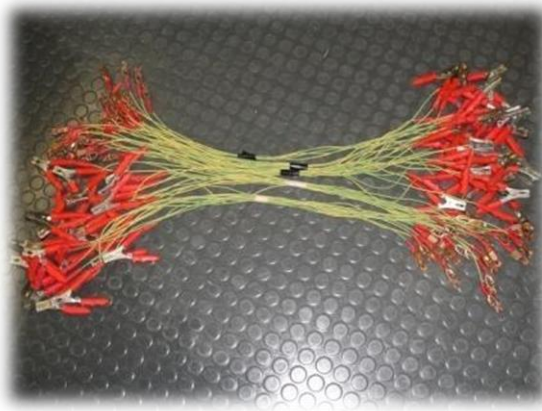
Figura 29: cavetti di connessione elettrodo-cavo multipolare con pinze “alligator” e “mueller clip”.
