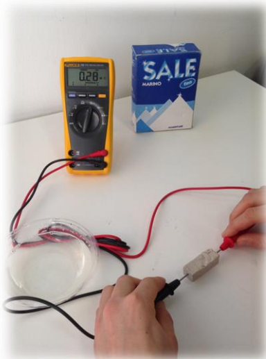
Figura 17: misura della resistenza del campione immerso nella soluzione acquosa con cloruro di sodio.
