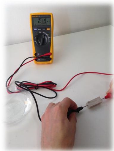
Figura 18: misura della resistenza del campione immerso in acqua “dolce”.
