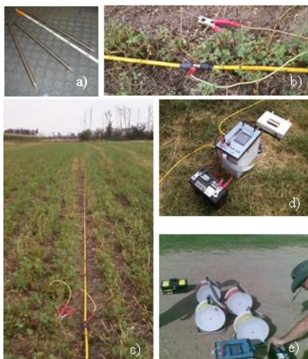
Figura 19: elettrodi di corrente (a), cavo di collegamento tra gli elettrodi (b, c), georesistivimetro (d, e).
