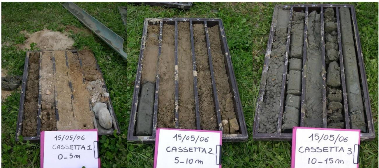
Figura 18: Foto delle cassette catalogatrici del sondaggio.
