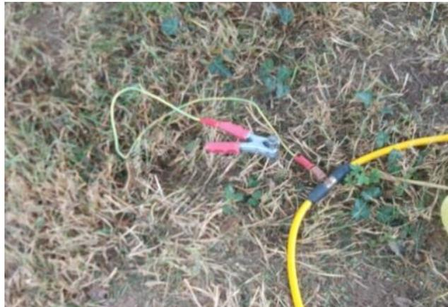
**Figura 23: cavetti di connessione elettrodo-cavo multipolare con pinze “alligator” e “mueller clip”.**
