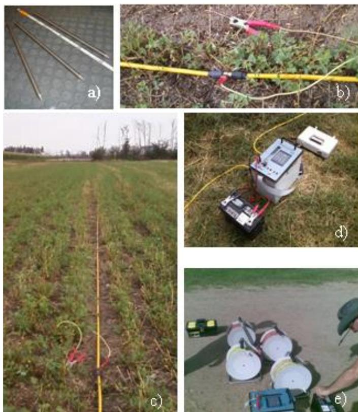
Figura 13: elettrodi di corrente (a), cavo di collegamento tra gli elettrodi (b, c), georesistivimetro (d, e).
